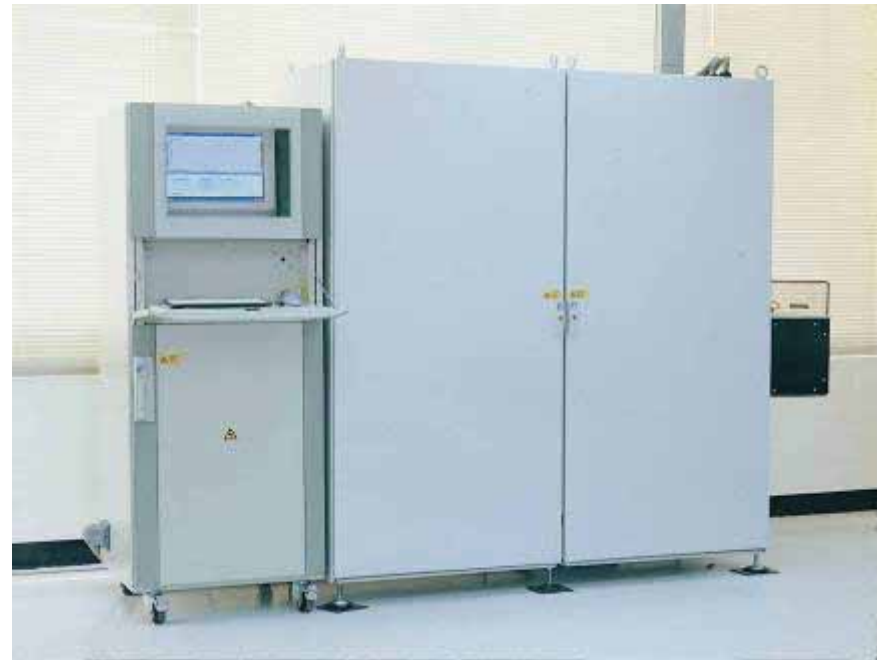
防爆能力測試 (1500A 300V AC)
