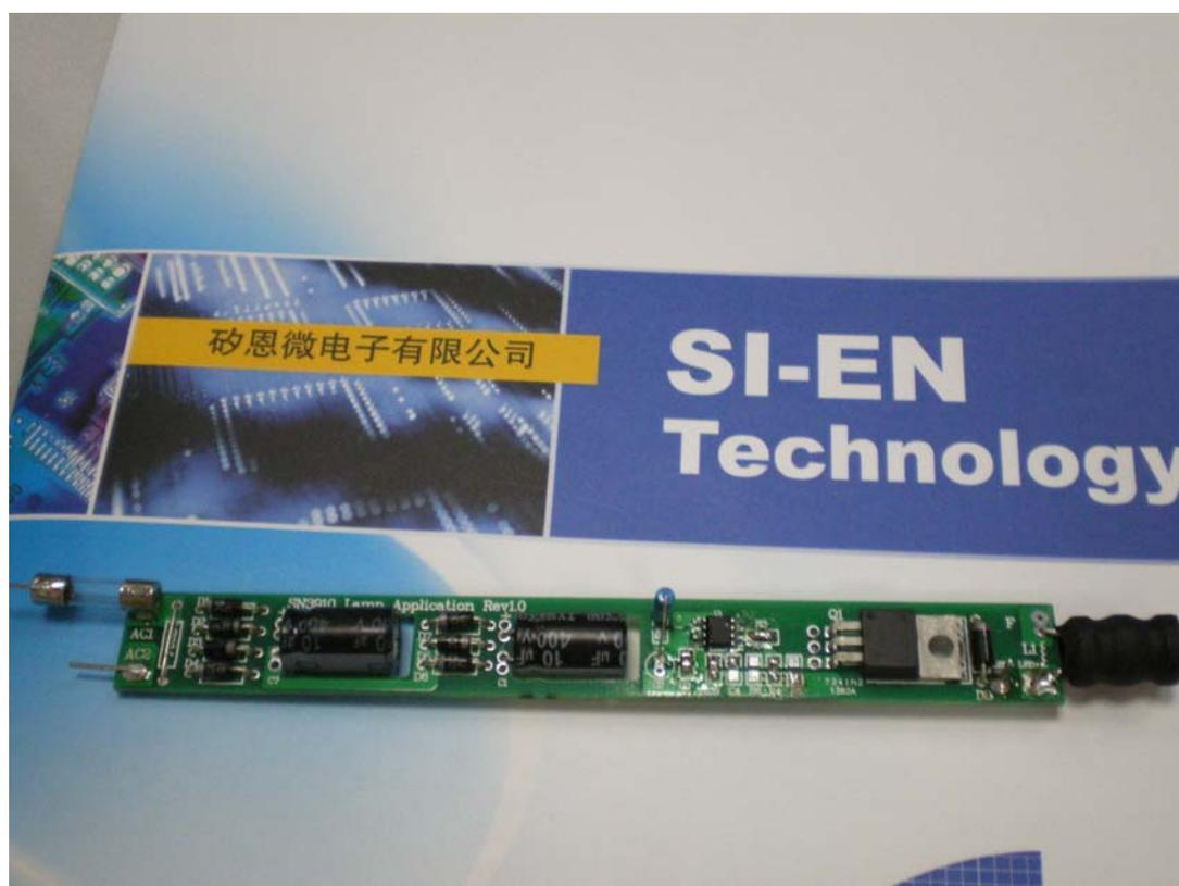
图2 通用高亮度LED驱动器的实物照片
