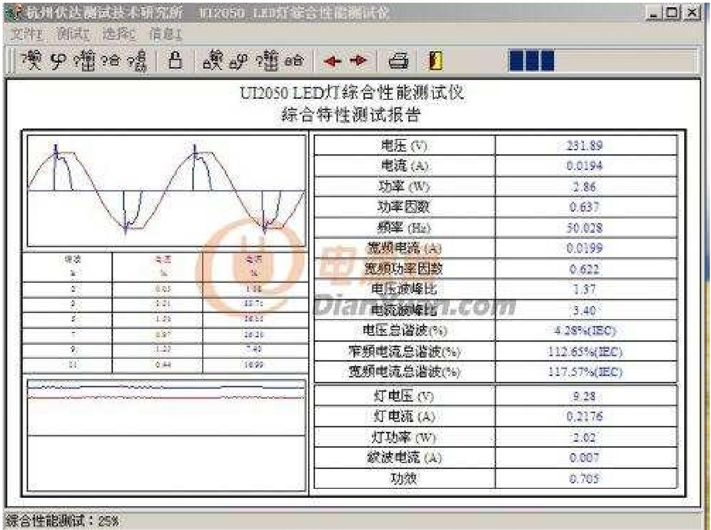
UI2050 测试仪是 LED 驱动电源综合测试仪，满足 GB/T 24825-2009 及 IEC62384:2006 等国内、国际标准对 LED 灯电性能的测试要求。
