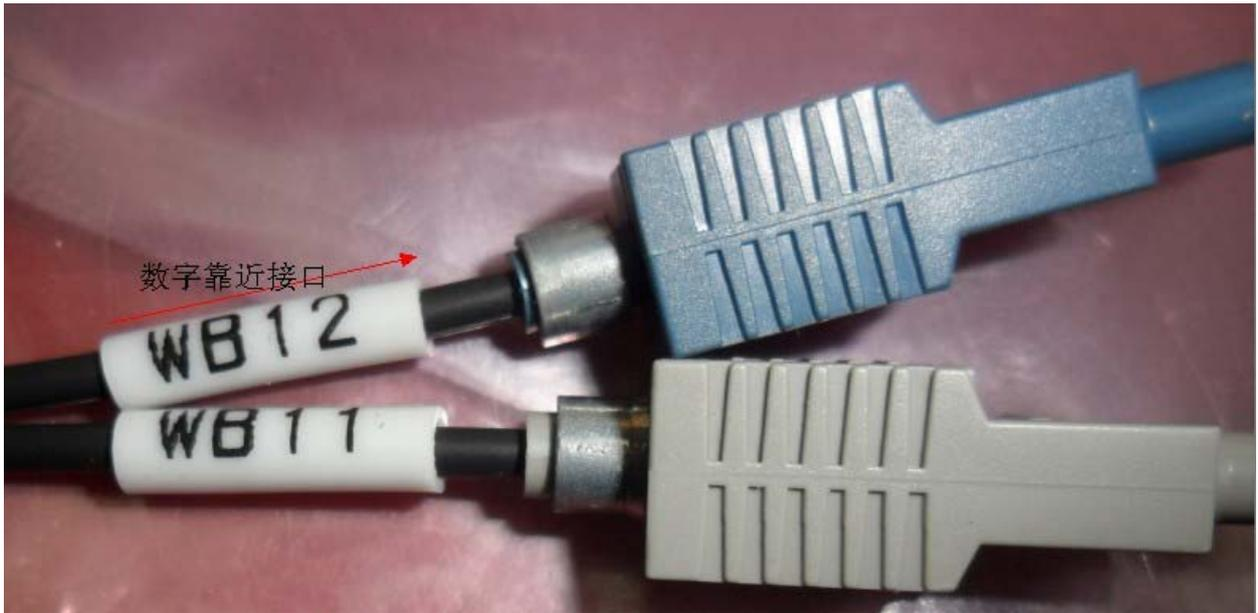
C、同一根线要求两端的标号一致；同一对线要求套上配对的线号管。
