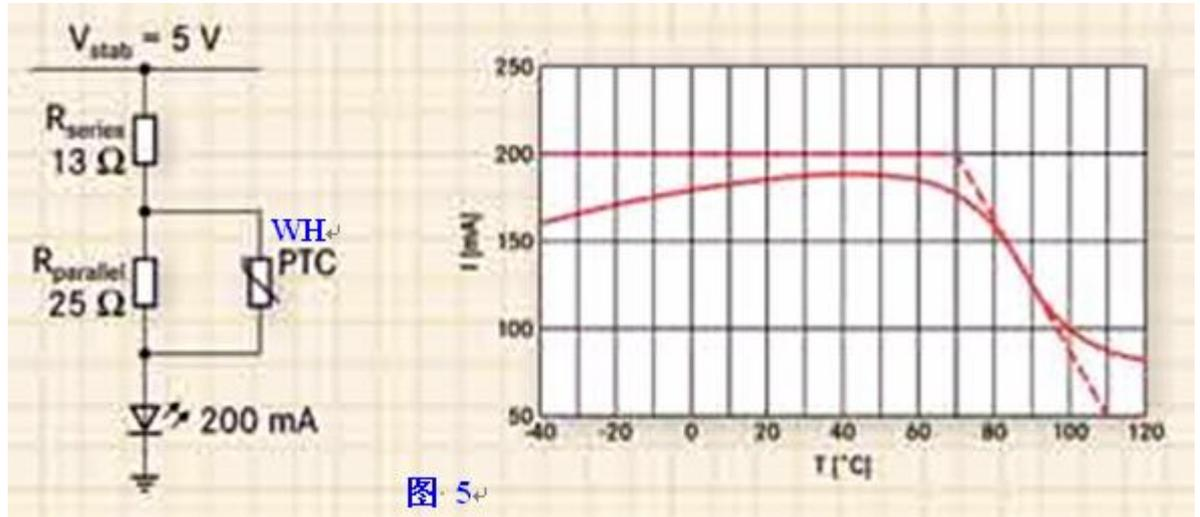
图 5 无需 IC 的温度补偿驱动电路
