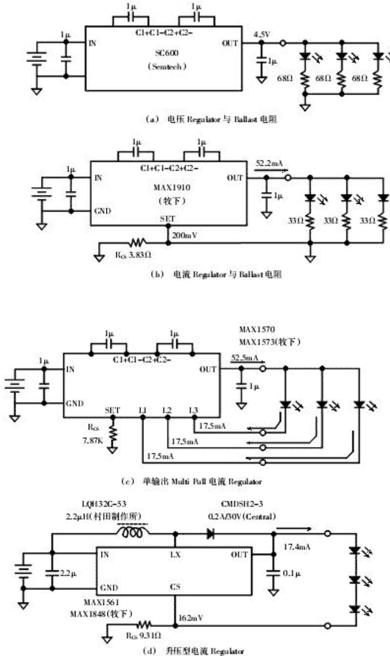
图 3 驱动白光 LED 常用的四种电源电路
