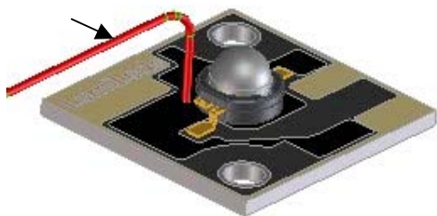
圖 10.監視 T 電路板 的熱電偶的位置。
