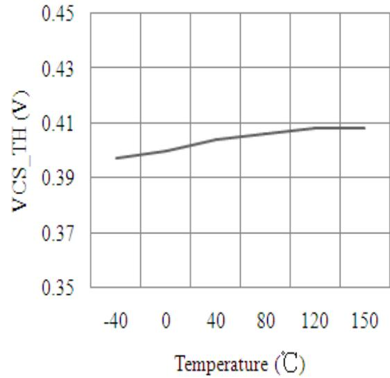
电流检测门限对温度的变化
