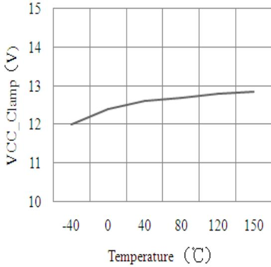
V<sub>CC</sub> 箝位电压对温度的变化
