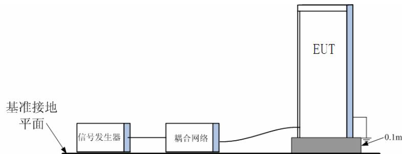
图 10 浪涌抗扰度试验配置图
