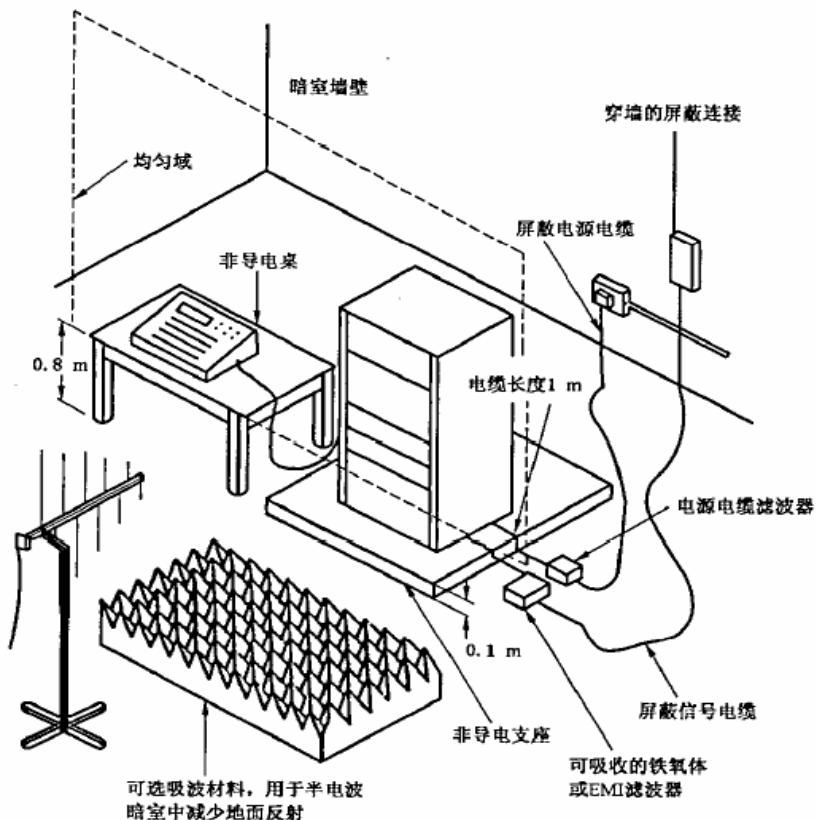
图 14 辐射电磁场抗扰度试验配置图
