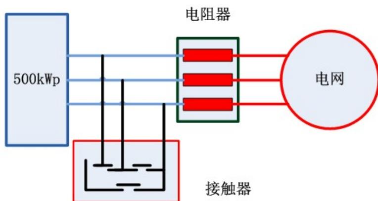
图 4 交流侧短路试验
