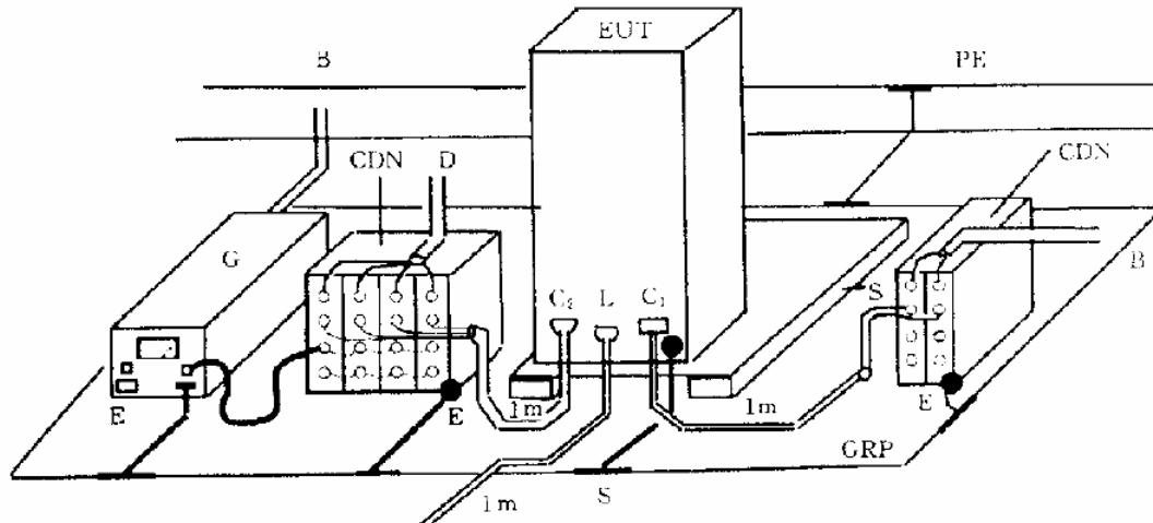
图 13 阻尼振荡波抗扰度试验配置图
