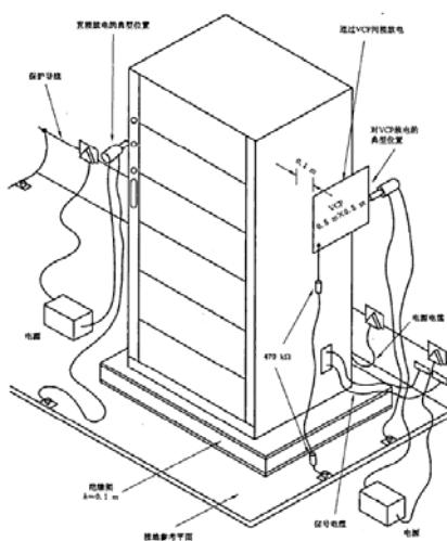
图 8 静电放电抗扰度试验配置图
