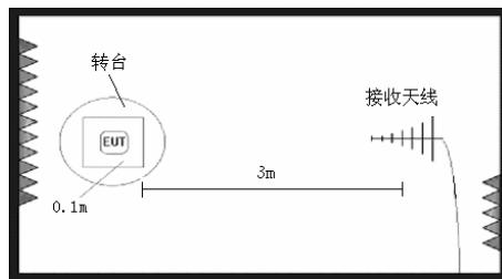
图 16 辐射发射试验配置图
