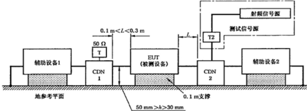
图 11 射频传导试验配置图
