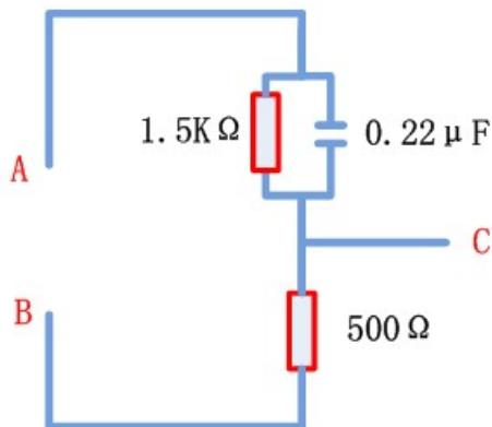
图 6 方阵残余电流试验
