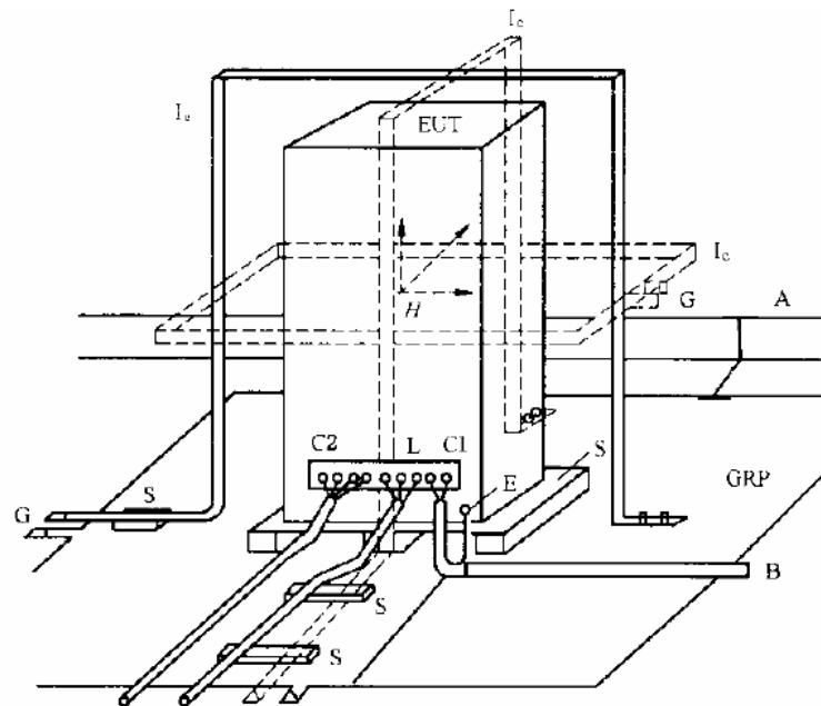
图 12 工频磁场抗扰度试验配置图
