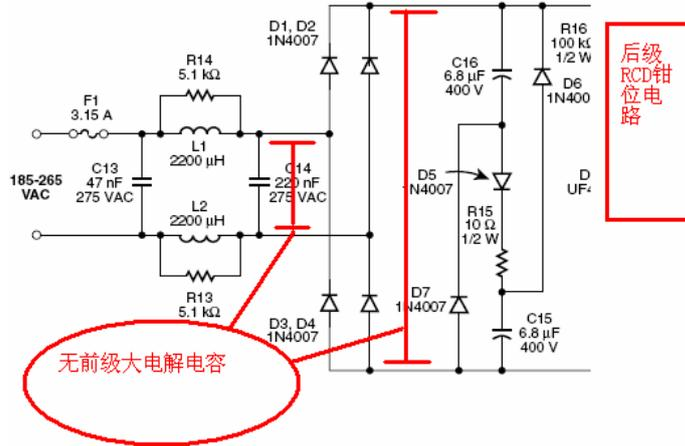
**问题 2:** 我也是菜鸟一个,在用填谷电路的时候也发现有这个问题.比如前端交流显示 AC90,到了填谷电路后端测直流电压才 60-80V,这样我在计算变压器的时候都不知道最小的输入电压该用多大的了!!有可能是填谷电路属于降压型的电路.关注中!
