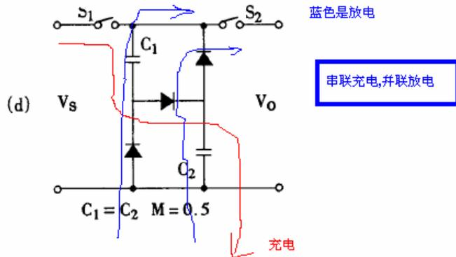
这是一种典型的逐流电路,90 年代在照明行业很流行,后来发现这种电路的缺点是供给开关管的直流电压波峰比很高,输出电流波峰比也很高. 填谷电路**不适合做降压型电源**的.因为填谷电路滤波的电路输出电压谷值只有电解滤波电路谷值的一半.
