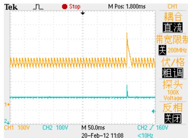
注：CH1为恒流二极管之前的电压波形 浪涌电压脉宽16ms
