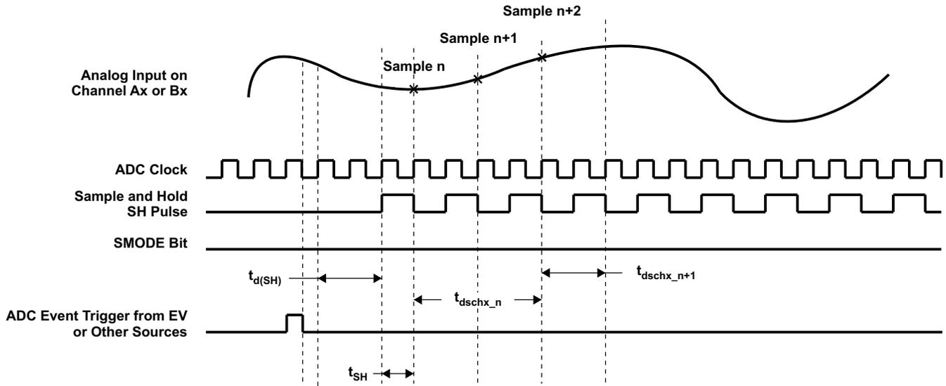
Figure 6-41. 顺序采样模式（单通道）时序
