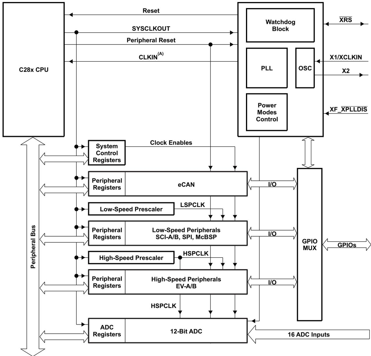
A. CLKIN 是到 CPU 的时钟输入。SYSCLKOUT 是 CPU 的输出时钟。它们的频率相同。
