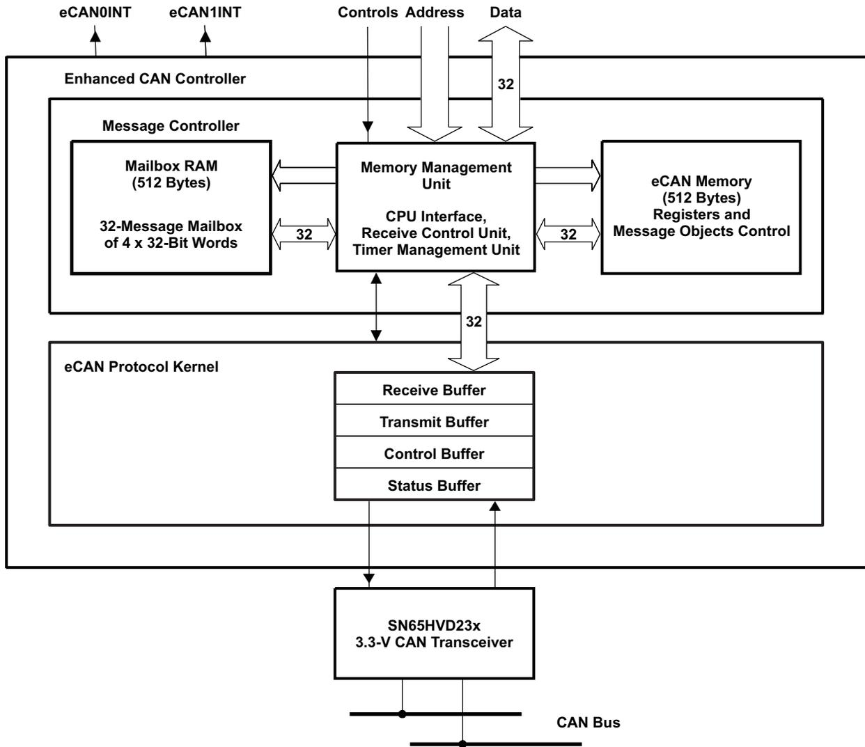
图 4-7. eCAN 方框图和接口电路
