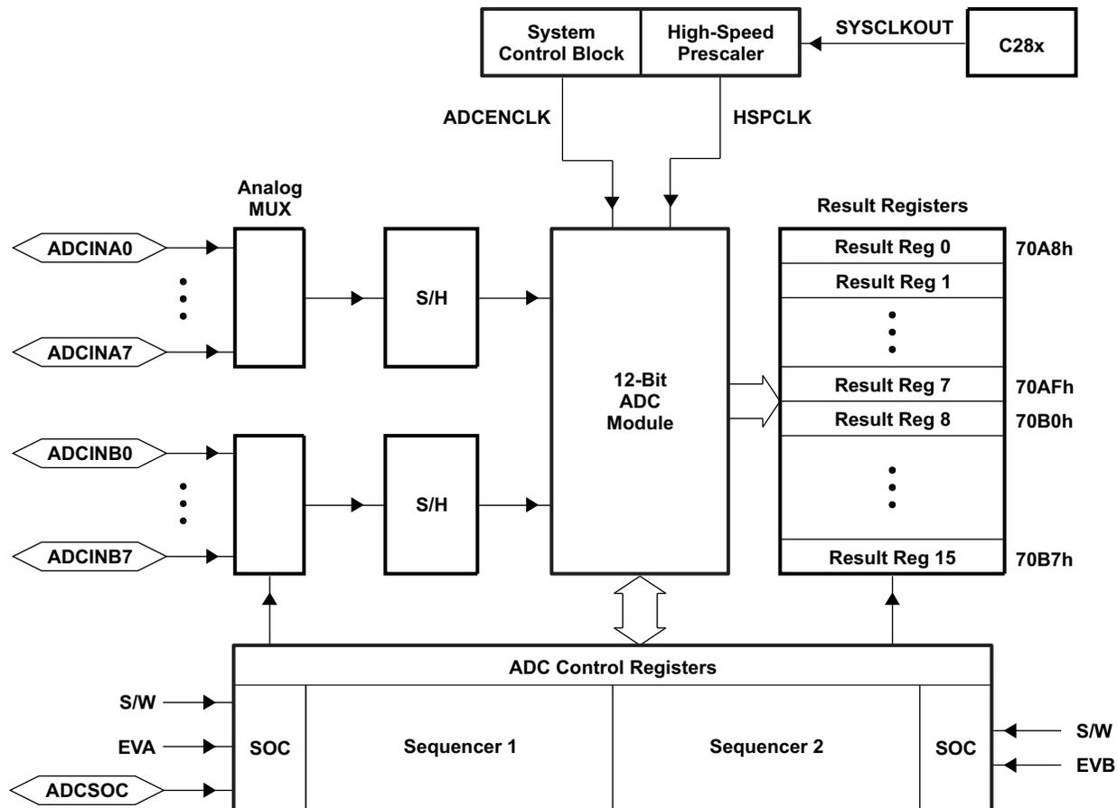
图 4-4. F281x 和 C281x ADC 模块方框图
