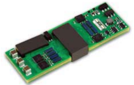
采用 PC2001 eGaN FET 和 LM5113 GaN FET 驱动器的 1/8 砖型模块电源。
