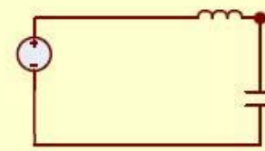
漏感放完后，Coss和初级漏感震荡
