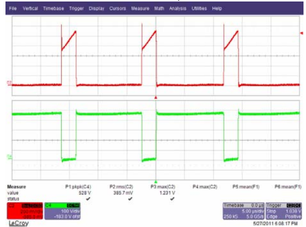
图26 – 265 VAC 50 Hz, 满载 上: I_{DRAIN} , 200 mA/格 下: V_{DRAIN} , 100 V, 5 \mu s/格
