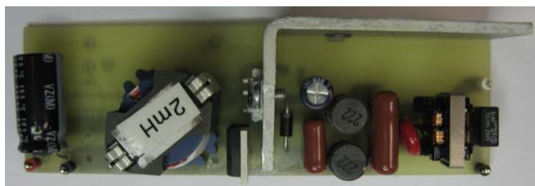
图3 – 装配后的电路板图片，采用RM8电感
