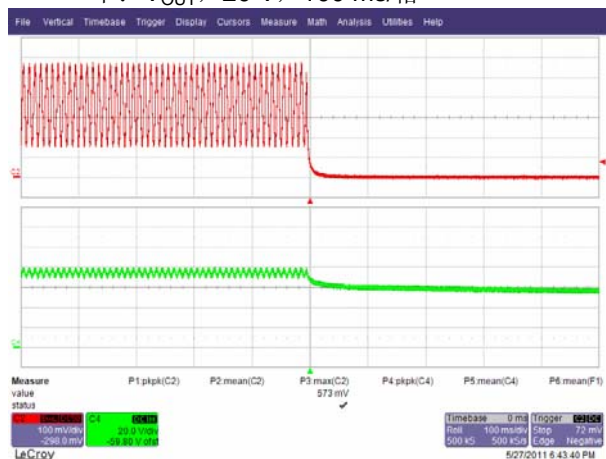
图36 – 265 VAC 50 Hz, 输出下降 上: I_{OUT} , 100 mA/格 下: V_{OUT} , 20 V, 100 ms/格
