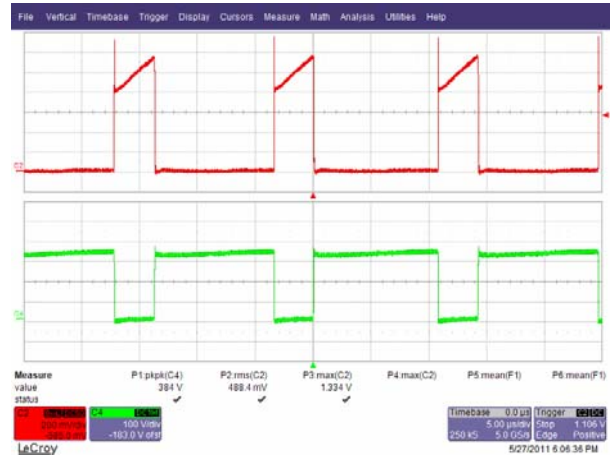
图24 – 180 VAC 50 Hz, 满载 上: I_{DRAIN} , 200 mA/格 下: V_{DRAIN} , 100 V, 5 \mu s/格
