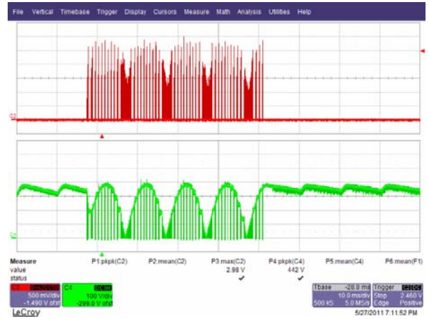
图38 – 265 VAC 50 Hz, 输出短路 上: I_{DRAIN} , 0.5 A/格 下: V_{DRAIN} , 100 V, 5 ms/格
