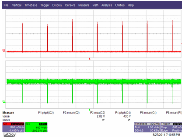
图37 – 265 VAC 50 Hz, 输出短路 上: I_{DRAIN} , 0.5 A/格 下: V_{DRAIN} , 100 V, 500 ms/格
