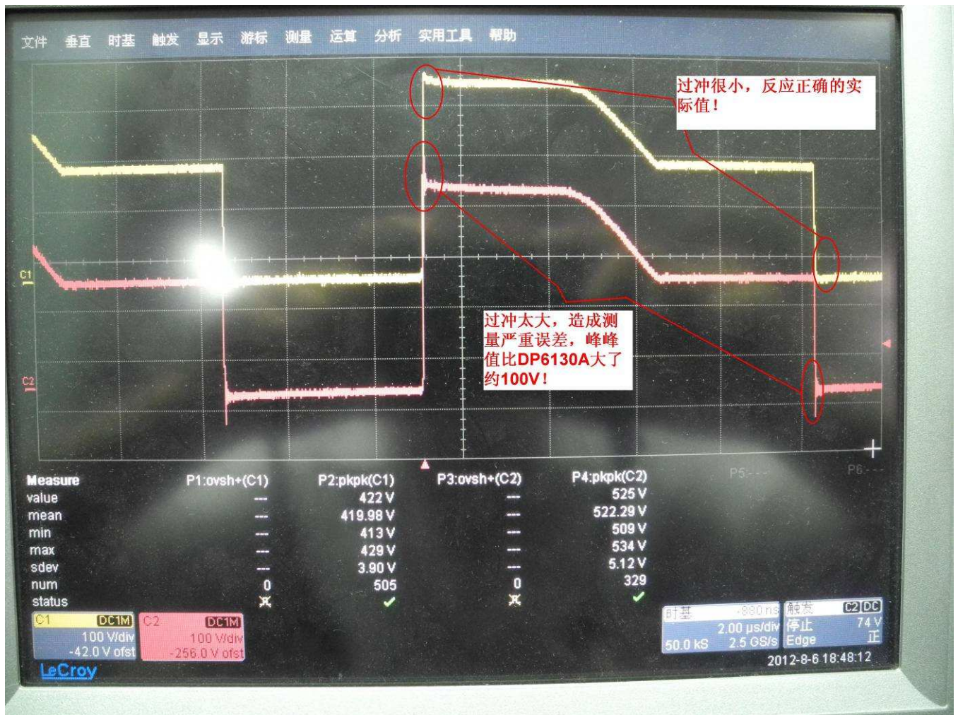
图31 实测波形，黄线为DP6130A，红线为P5200（二手的，维修过）
