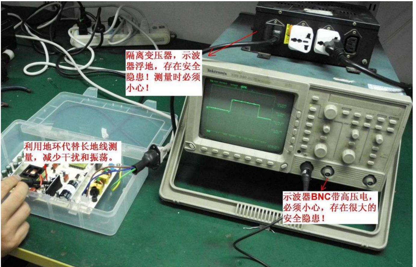
图23 利用地线环取代长地线的测量系统
