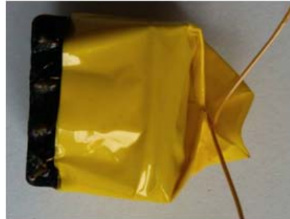
将悬在外面的绝缘胶带按照上图方式 折好（线也被折起来） 第 2 步
