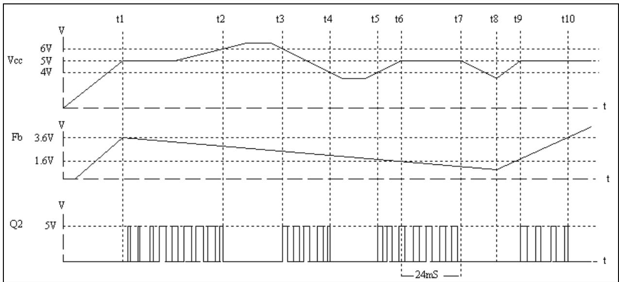
电路在 t1 时间 Vcc 电压上升到 5V，电路开启工作，Q2 输出 PWM 信号，t2~t3 时间 Vcc 电压高于 6V，电路停止输出，Q2 输出低电平，t3~t4 时间 Vcc 电压回到范围之内，电路正常工作，t4~t5 时间 Vcc 电压低于 4V，电路停止输出，Q2 输出低电平，t6 时间 Fb 电压低于 1.6V，开路开启一个 24mS 的定时器，PWM 以最大占空输出，直到 t7 时间 Fb 电压还未能高于 1.6V，电路开始重新启动，t9 时间 Vcc 电压上升到 5V，电路重新开启工作，t10 时间 Fb 电压高于 3.6V，电路停止输出。
