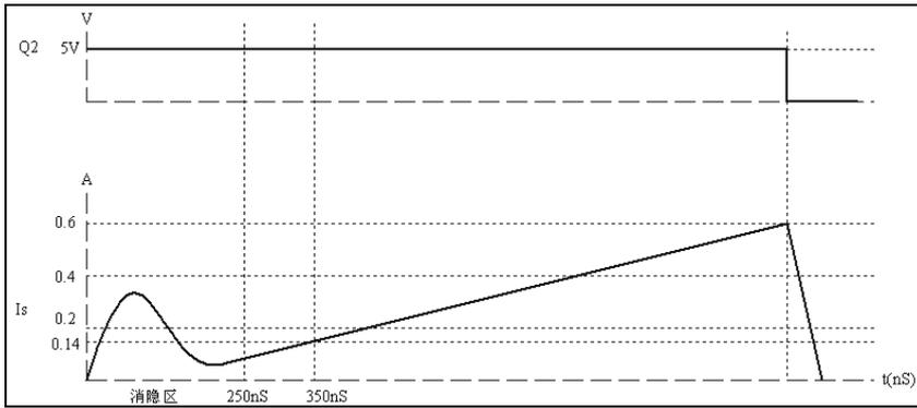
根据电感电流公式  $I=U/L*\Delta t$  可知，在电感不变时，在一个固定的时间上检测电流可计算出电压，芯片利用该原理在 350nS 时检测 Is 电流，当 Is 电流小于 0.14V 时，电路正常工作，当 Is 电流大于 0.14V 时，芯片进入异常保护；同理，当外部的电感器的电感量变小，也会让芯片进入异常保护；这样即可以保护母线电压过高引起的开关管的击穿，也可以保护因外部变压器的饱和或者短路引起的电感量下降导致 Is 电流过大，引起芯片的损坏。
