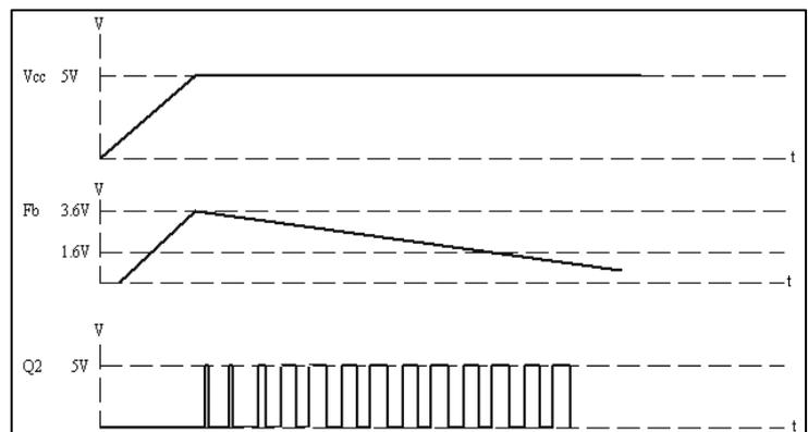
◆ **正常工作:** 电路完成启动后, 振荡器开始工作, 触发器的 Q1, Q2 输出高电平, 高压晶体管与功率 MOS 管同时导通, 开关电流经晶体管与功率 MOS 管接到 40  $\Omega$  电流取样电阻, 并在电阻上产生与电流成正比的电压, (由于开关变压器分布电容的存在, 在电路开通的瞬间有一个高的尖峰电流, 为了不
