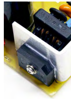
将封装的整流桥连接到散热片
