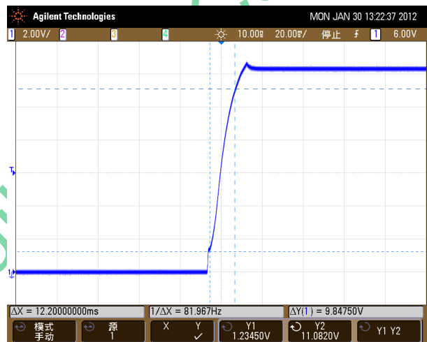
图 10 264Vac 满载起动输出上升时间
