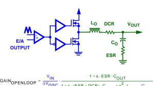
FIGURE 4. THE OPEN LOOP SYSTEM
