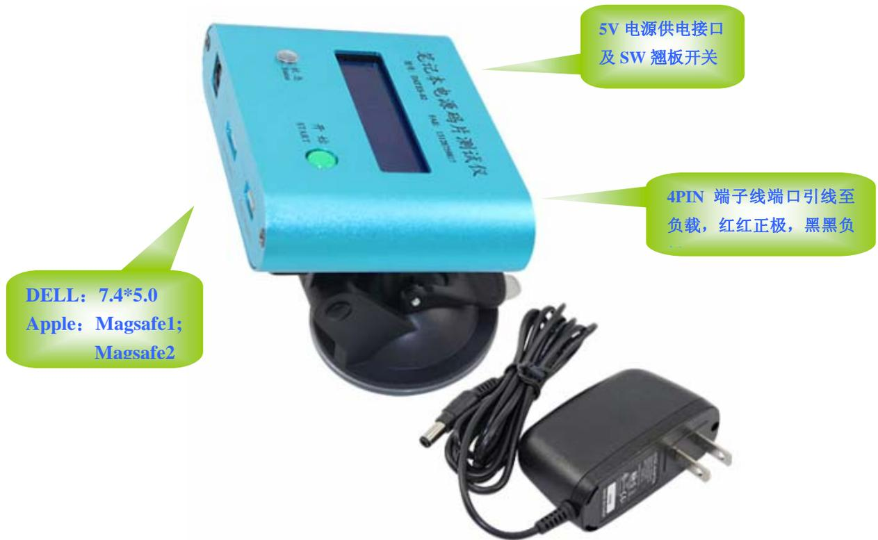
(测试接口输入电压范围, 0-30V DC, 电流 0-8A)
