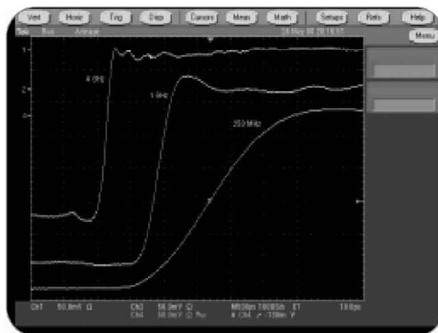
► 图47. 带宽越高，信号的再现越准确，图示信号的捕获速率分别是250MHZ、1GHZ 和4GHZ 带宽等级
