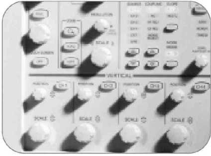
► 图 60. 传统模拟示波器风格的按钮将如您所愿地精确地控制位置、刻度和亮度，等等。
