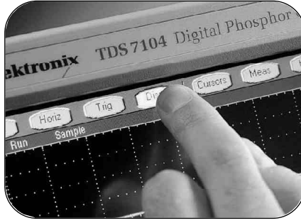
► 图 61. 通过提供清楚的屏幕按钮，触摸显示屏可自然地解决凌乱的内容。
