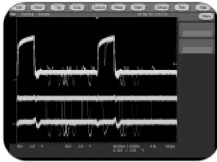
► 图 52. 通过提供更高的波形捕获速率和三维显示, DPO 可以得到更高等级的信号特性, 使其在一系列应用中, 成为最通用的设计和故障检修工具。
