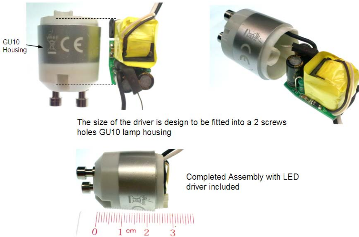
图 2—GU10灯座内部装配后的驱动器。
