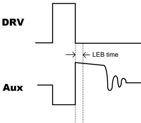
图3、辅助绕组电学参数检测
