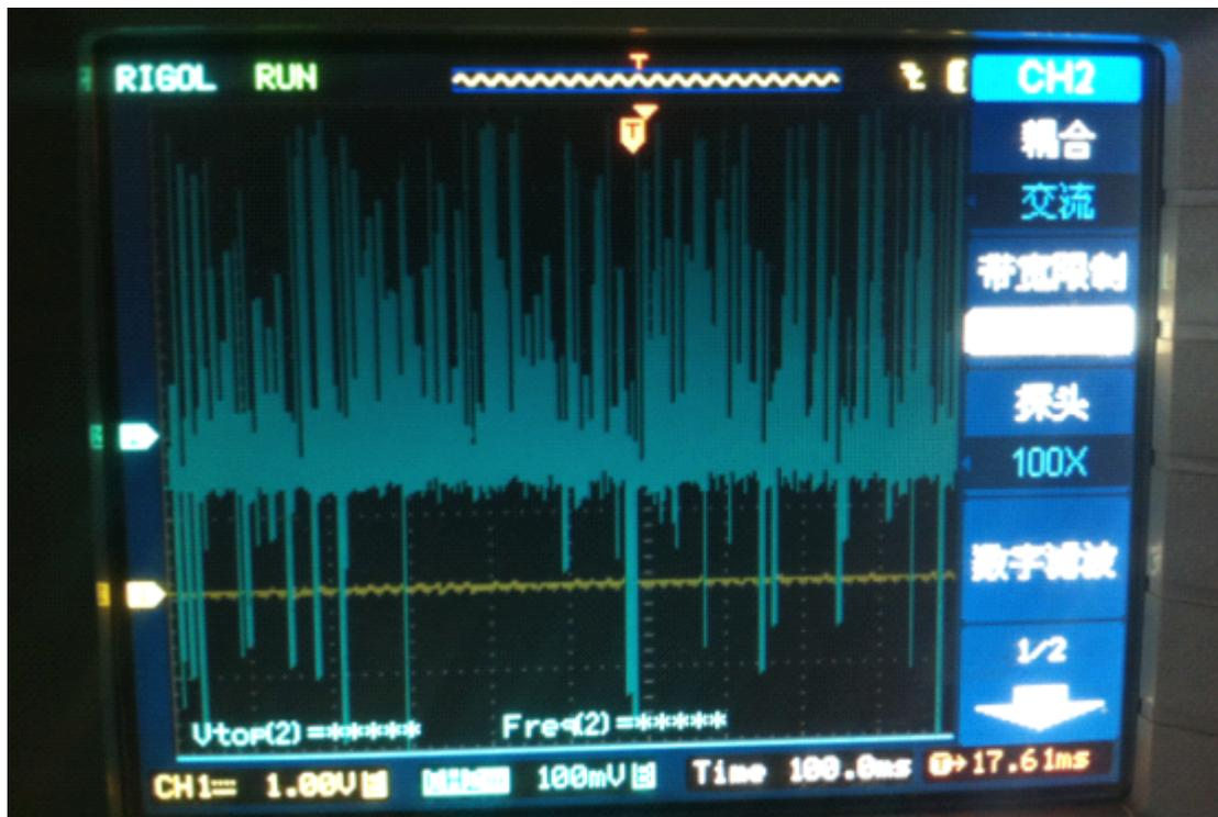
下图是用高压探头×100 测试的，带地线夹，测试点为 LC 滤波器后端
