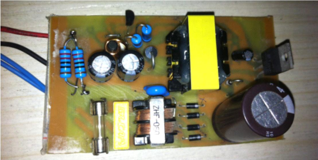
电路板反面：光耦反了，吸收阻容后改的。反馈分压电阻在这一面是贴片封装。
