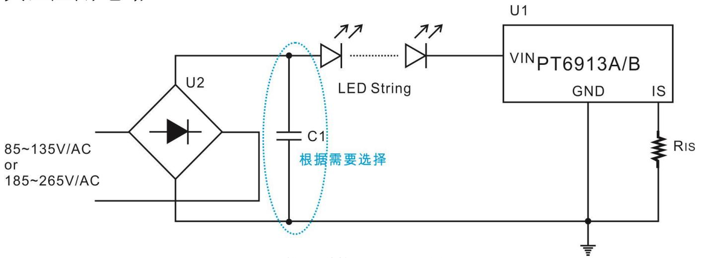
超高压线性恒流 LED 驱动电路
