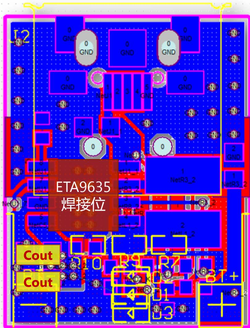
1. 永远第一优先放置输出电容Cout (22uF x 2) , 使其距离 IC 输出(Pin5)和GND(Pin6) 越近越好。
