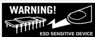
注意：本产品为静电敏感元件，请注意防护！ESD 损害的范围可以从细微的性能下降扩大到设备故障。精密集成电路可能更容易受到损害，因此可能导致元件参数不能满足公布的规格。
