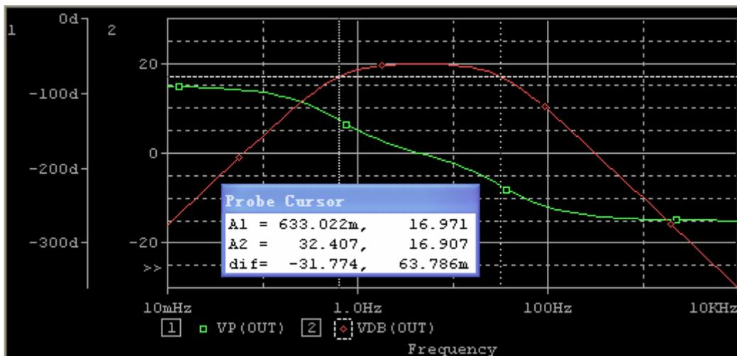
图 3.3.2: 使用真实运算放大器 U741 的有源滤波器电路的交流扫描结果
