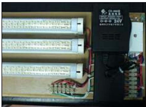
图 11、光敏自动调光 LED 灯具的方框图和实物图
